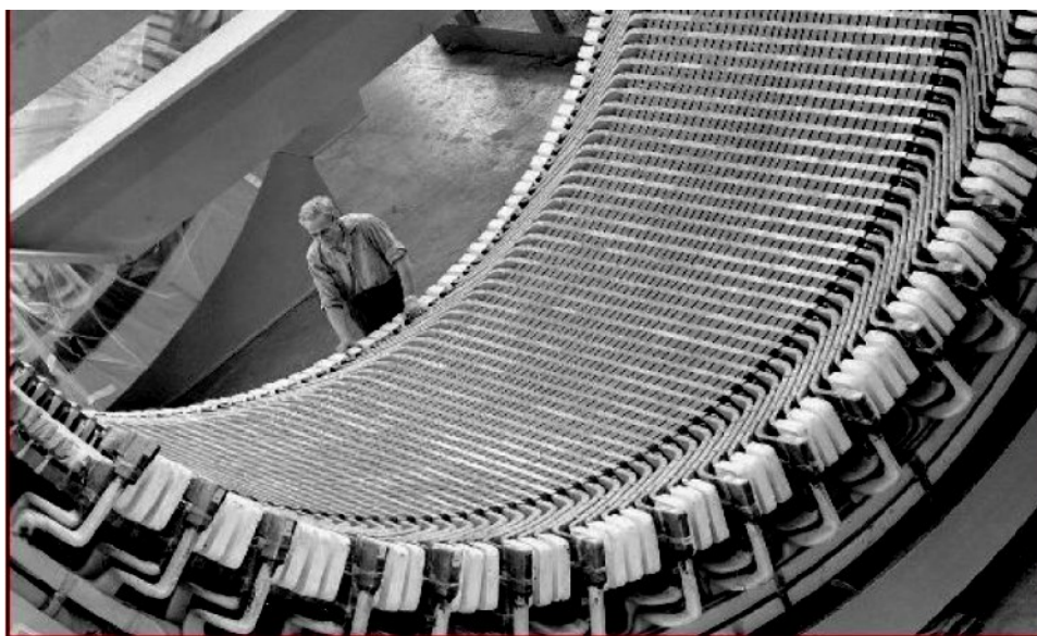
Stabilimento Asgen Ansaldo di Genova, un operaio di fronte a un gigantesco alternatore costruito per la centrale idroelettrica di Inga, negli Anni 60
